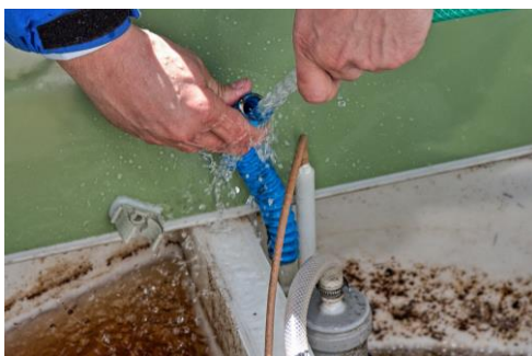
Rinçage des tuyaux par de l'eau propre
